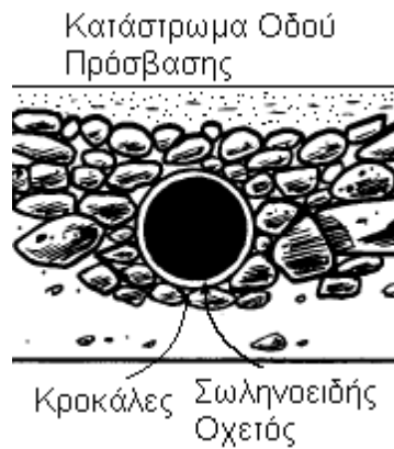
Εικόνα 13 Τυπική τομή στις θέσεις διασταύρωσης της οδού με μισγάγγειες
